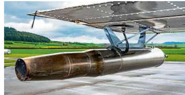
Der Silberjodid-Generator befindet sich unter der Tragfläche, jetzt ist sogar ein gezieltes Sprühen möglich. BILD: GÖTZ
