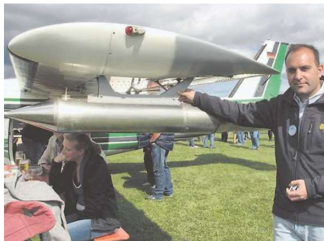
Die Menschen in Villingen-Schwenningen und der Region verlassen sich auf den Hagelflieger. So langsam erkennen auch Versicherungen den Wert der Abwehrflugzeuge, die in diesen Generatoren Silberjodid erzeugen, das Wolkenfronten abregnen lässt.
