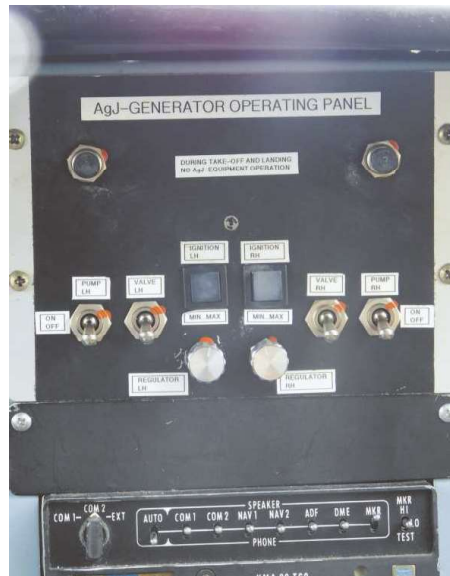
Das Instrumentenpanel, mit dem die Generatoren unter den Flügelspitzen angesteuert werden können.
